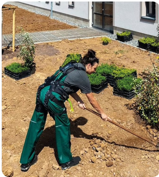
UN ESOSCHELETRO RENDE PIÙ FACILI ATTIVITÀ COME SCAVARE, RIVOLTARE IL TERRENO E ARARE, CHE SPESSO RICHIEDONO UNA POSTURA PIEGATA. FOTO: HTRIUS
